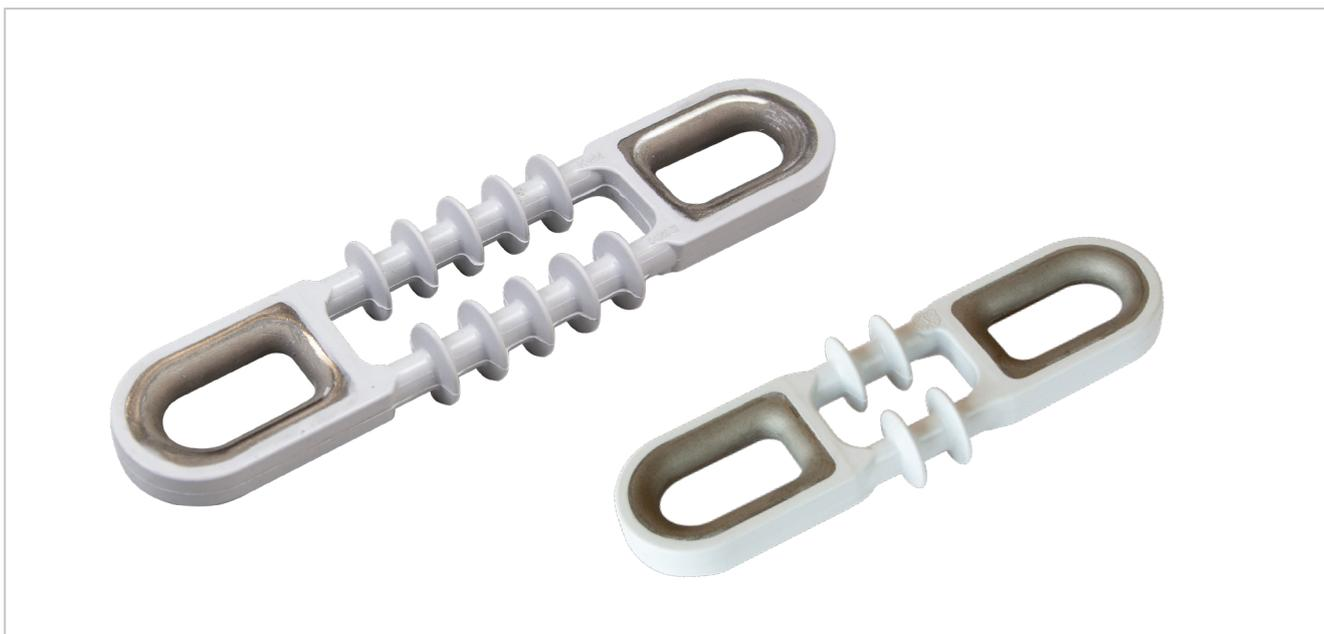
Die KULOOP Schlingen-Isolatoren 3 kV und 1.5 kV DC sind eine kompatible Weiterentwicklung der herkömmlichen Schlingen-Isolatoren ohne Siliconüberzug und wurden gemäss Norm EN 50119 erfolgreich getestet. Um eine langlebige Verbindung zu ermöglichen, wurde der Kern beider Isolatoren aus glasfaserverstärktem Kunststoff mit UV-resistentem Siliconüberzug und die Kauschen aus korrosionsbeständigem Material gefertigt. Die Kauschen bestehen aus korrosionsbeständigem Material. Aufgrund
