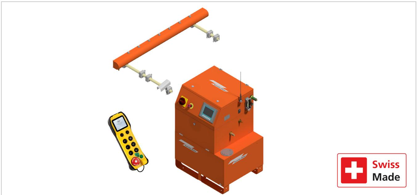
Im Enteisungssystem KUPRO sind alle Komponenten in einer kompakten Anlage untergebracht. Diese Anlage wird innerhalb eines Fahrzeuges oder eines Wagenaufbaues installiert und mit Hilfe einer Funkfernsteuerung einfach vom Cockpit aus bedient. Die Anlage ist über die Versorgungsleitung mit einem am Stromabnehmer (Pantograph) montierten Sprühmodul auf dem Fahrzeugdach verbunden. Das Sprühmodul ist mit Sprühdüsen sowie einem Sensor zur Detektion der genauen Fahrdrachtlage bestückt. Die
